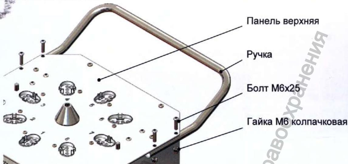
Рис. 17. Установка ручки
